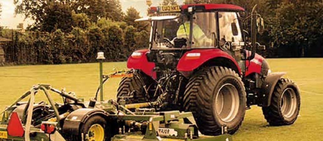
Nieagresywna rzeźba bieżnika opon do prac wykonywanych na delikatnej darni pól sportowych.
