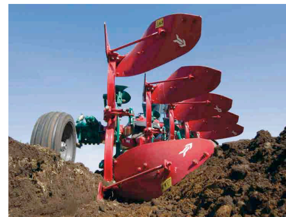
Profil skiby dla korpusu nr 28 Głębokość orki: 26 cm, szerokość dna bruzdy: 30 cm, szerokość otwarcia bruzdy 73 cm
