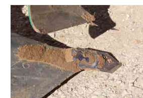
Kształt dłuła Knock-on® zabezpiecza inne elementy przed zużyciem
