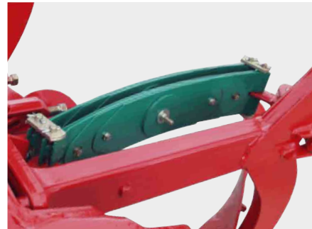
Zabezpieczenie podwójne z 14 resorami (1400 kg)
