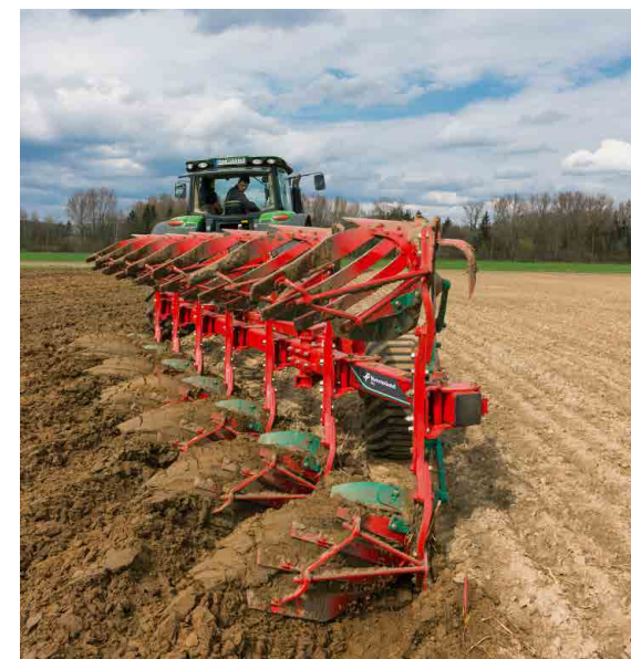
Pług Kverneland RG z poszerzaczem bruzdy.
