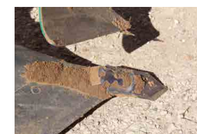
Kształt dłuła Knock-On® zabezpiecza inne elementy.
