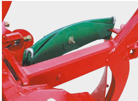
zabezpieczenie typu HD z 9 resorami (900 kg)
