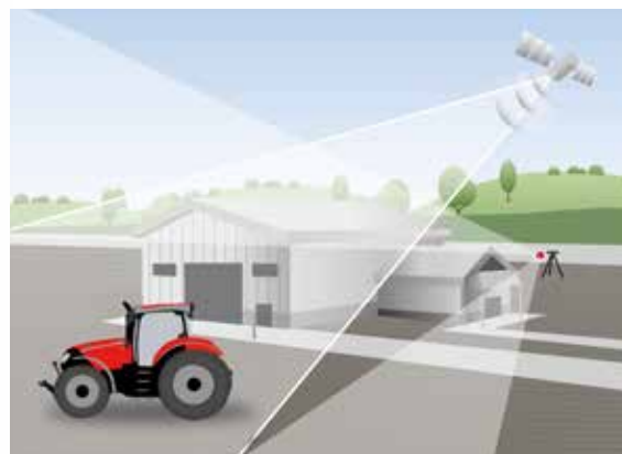
xFill kompensuje RTK+ nawet 20-minutowe przerwy w odbiorze sygnału.
