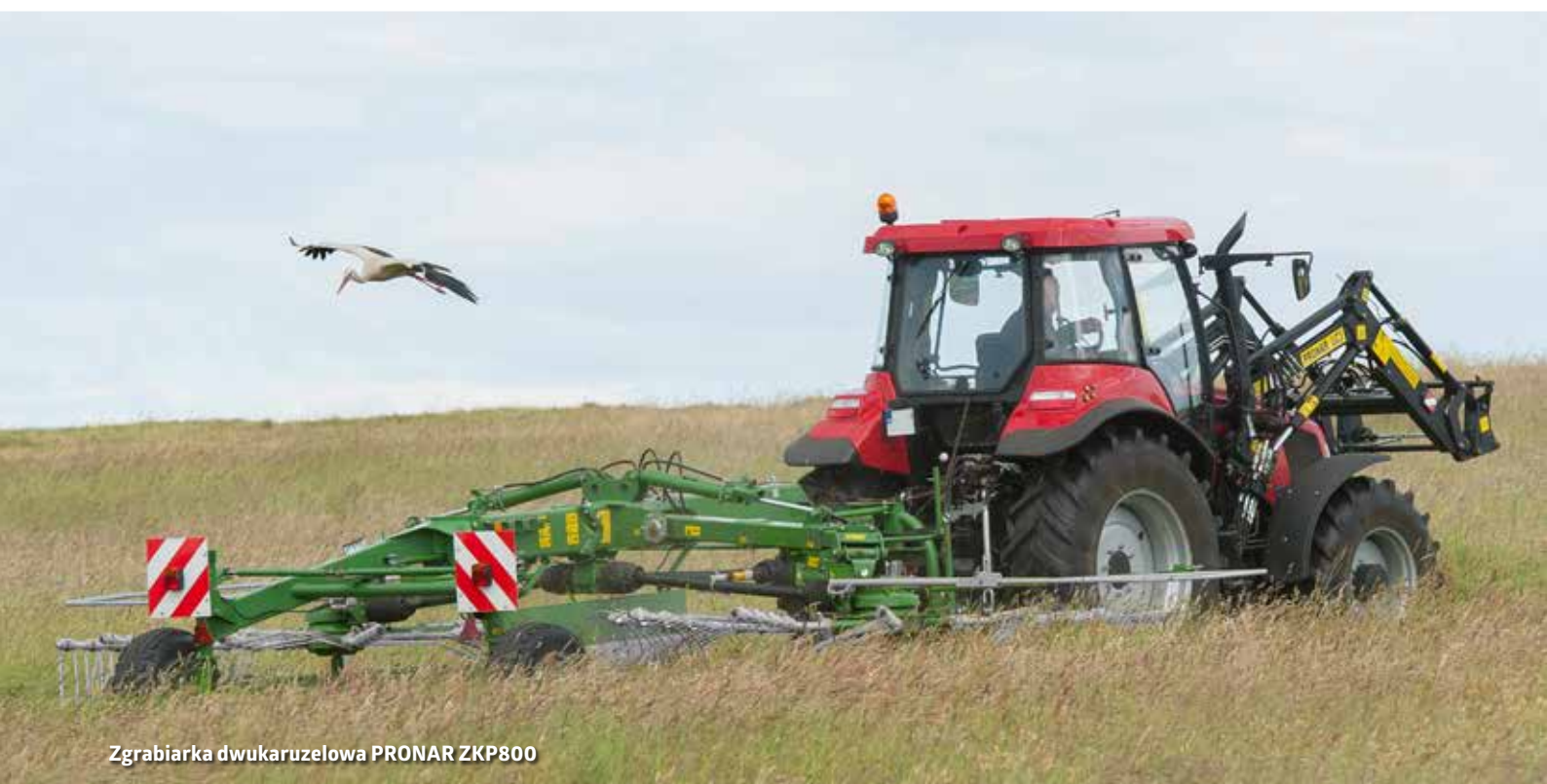
Siłowniki hydrauliczne regulujące szerokość roboczą maszyny – 7-8 m
