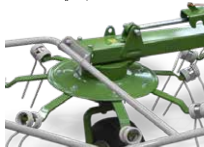
Palce przetraszacza - wysoka jakość z odpowiednią elastycznością
