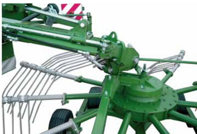
Siłowniki hydrauliczne regulujące szerokość roboczą maszyny – 7-8 m
