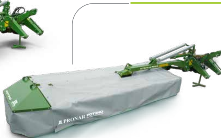
PRONAR PDT300 - pozycja transportowa pionowo z boku ciągnika
