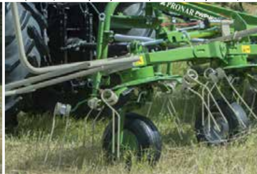
Palce przetraszacza - wysoka jakość z odpowiednią elastycznością
