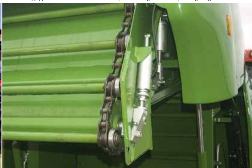
Łańcuch rolujący pozwala na zbiór zarówno mocno przesuszonego materiału, jak i wilgotnego
