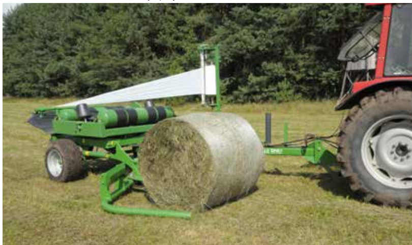
Załadunek czołowy z podjazdem do boku beli
