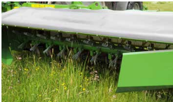
Spulchniacz przyspiesza przygotowanie paszy, jednocześnie zapewniając jej wysoką jakość
