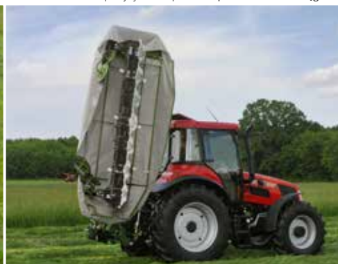
PRONAR PDT300 - pozycja transportowa pionowo z boku ciągnika
