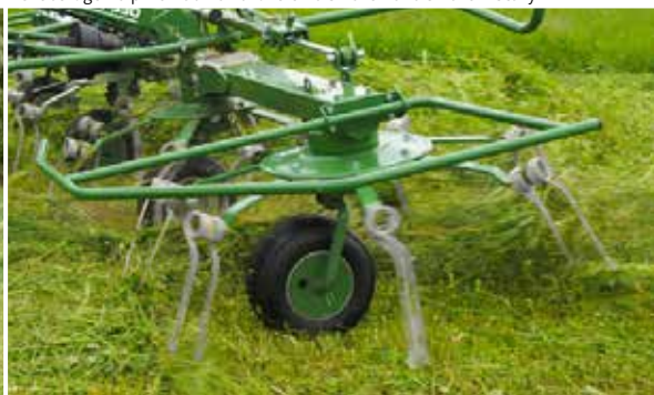
Bezobsługowa przekładnia karuzelowa smarowana smarem stałym
