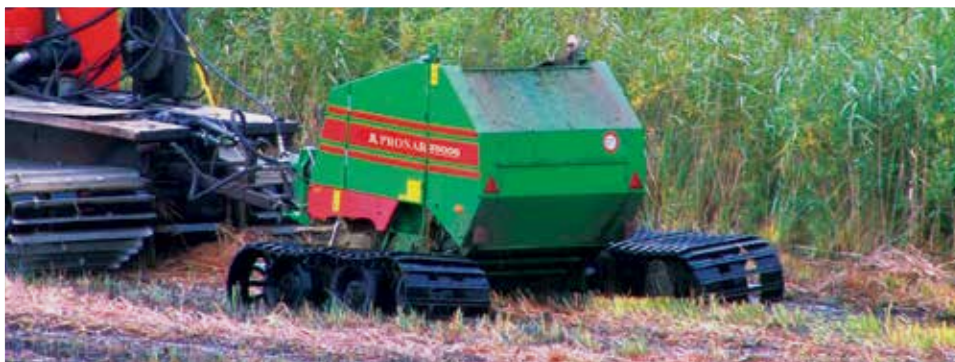
Prasa PRONAR Z500G - gąsienicowy układ jezdny pozwala pracować na podmokłych i bagiennych terenach
