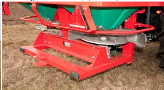
Tarcze rozsiewające z blachy kwasoodpornej odporne na korozję
