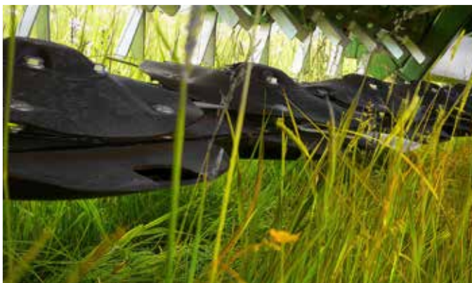
Palce urządzenia, wykonane ze stali odpornej na ścieranie, przechwytyują skoszony materiał z listwy tnącej
