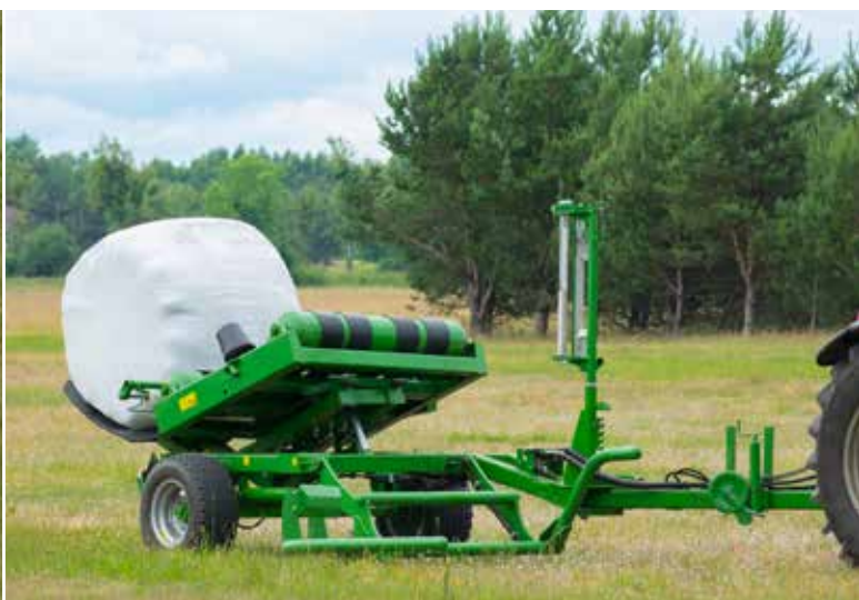
Możliwość odkładania bel na boku lub czołowo
