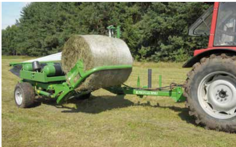
Możliwość odkładania bel na boku lub czołowo
